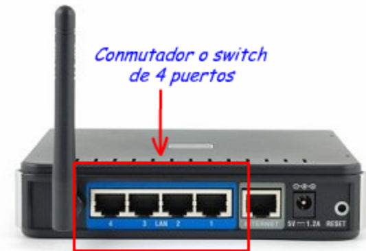
Vista posterior del router. Tiene integrado un conmutador de 4 puertos. En cada puerto se puede conectar un ordenador mediante un cable.
